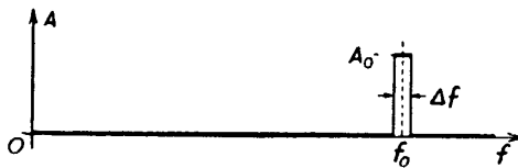
Fig. 1 — Curva di risposta ideale di un amplificatore per oscillazioni modulate.
